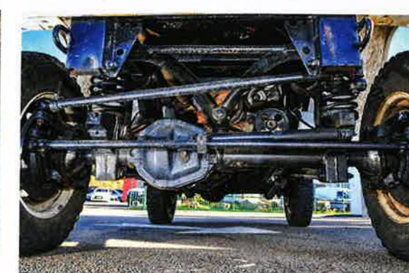
Rustique signifie aussi accessibilité mécanique facile. Une autre philosophie de l'automobile. Les dessous de l'Auverland resteront identiques durant toute sa carrière. Ponts rigides et suspensions à ressorts hélicoïdaux ont forgé sa réputation de robustesse.
