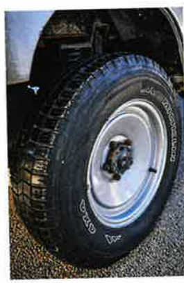
Les Michelin 4x4 XPC en 215/80 R16 sont ici montés sur des jantes pleines d'origine Auverland.
