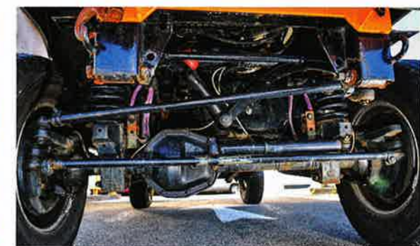
Les ponts (ici version Carraro), disposent d'un différentiel à glissement limité à l'arrière. Les suspensions à ressorts hélicoïdaux sont très souples. Idéal en off road, un peu plus délicat sur route.
