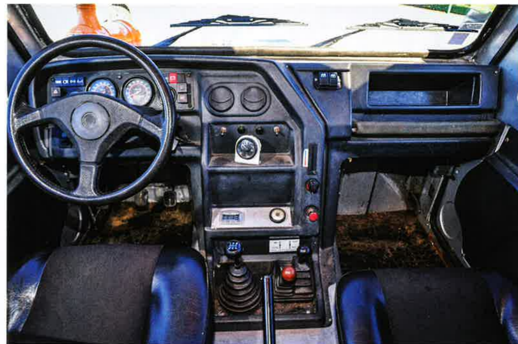
Côté tableau de bord, on verse dans la simplicité avec des plastiques de l'époque peu séduisant. Mais c'est aussi tout le charme des Auverland avec son compteur gradué aussi en miles pour l'export... L'œil attentif aura remarqué les lave-vitres électriques et le chauffage à deux vitesses.
