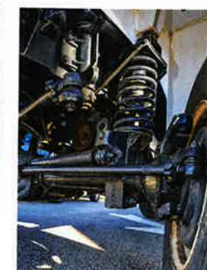
Rustique signifie aussi accessibilité mécanique facile. Une autre philosophie de l'automobile. Les dessous de l'Auverland resteront identiques durant toute sa carrière. Ponts rigides et suspensions à ressorts hélicoïdaux ont forgé sa réputation de robustesse.
