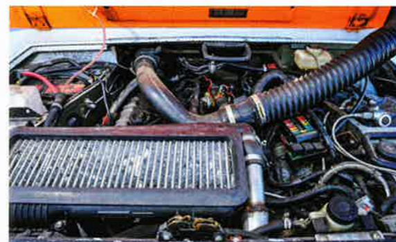
Sous le capot trône la version TD du bloc 4-cylindres XUD Peugeot de 92 ch. Pierre a déplacé l'intercooler afin qu'il soit mieux refroidi par l'air entrant.
