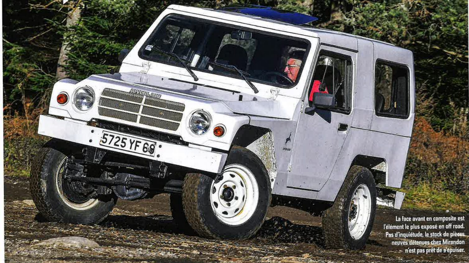
Sous le capot, le XUD9 version atmosphérique et ses 63 ch est un peu à la peine sur la route. Mais une fois en off road cela suffit et son couple bien que modeste, est un atout appréciable en franchissement.
