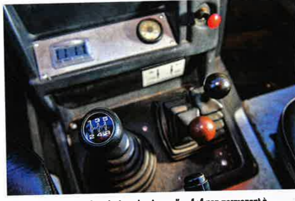
Boîte 5 rapports et les deux leviers classiques d'un 4x4 non permanent à boîte de transfert à deux rapports.
