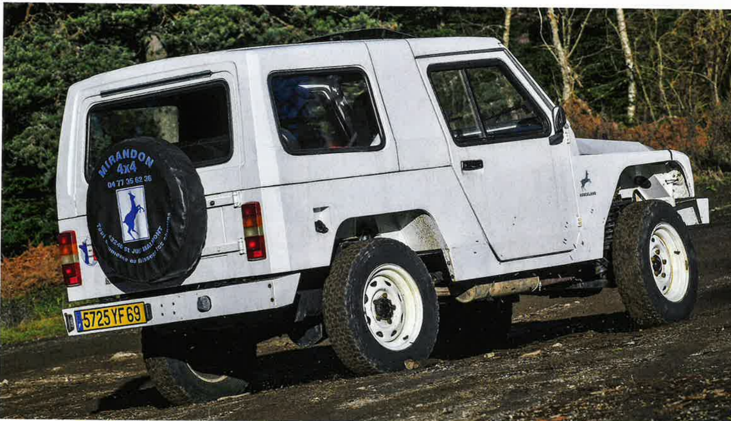
Sous le capot, le XUD9 version atmosphérique et ses 63 ch est un peu à la peine sur la route. Mais une fois en off road cela suffit et son couple bien que modeste, est un atout appréciable en franchissement.
