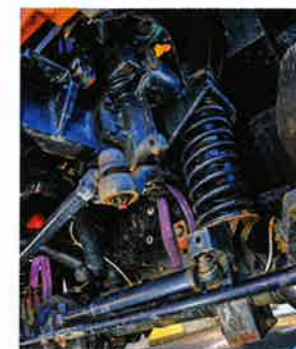
Les ponts (ici version Carraro), disposent d'un différentiel à glissement limité à l'arrière. Les suspensions à ressorts hélicoïdaux sont très souples. Idéal en off road, un peu plus délicat sur route.
