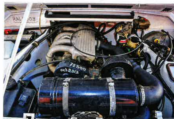
Sous le capot, le XUD9 version atmosphérique et ses 63 ch est un peu à la peine sur la route. Mais une fois en off road cela suffit et son couple bien que modeste, est un atout appréciable en franchissement.
