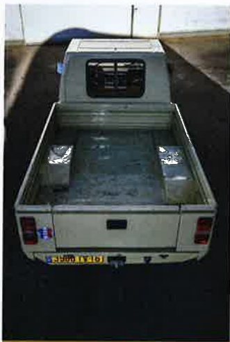
Assez rare, les versions pick-up dites "Super long" avaient un empattement de 3 m et disposaient d'une benne capable de recevoir deux palettes standard.
